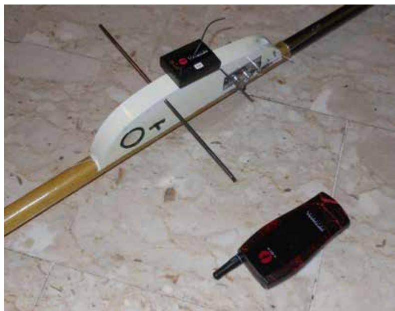
Il dispositivo "cercamodello" è un sistema ricevente/trasmittente che facilita il ritrovamento con un indicatore di distanza, direzione e con un cicalino
