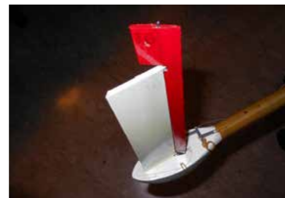
L'impennaggio verticale di prua con la parte mobile inclinata a simulare l'azione di correzione. Il direzionale magnetico dispone di una massa sottostante di circa 80 gr di Ferrite o 60 gr di Neodimio
